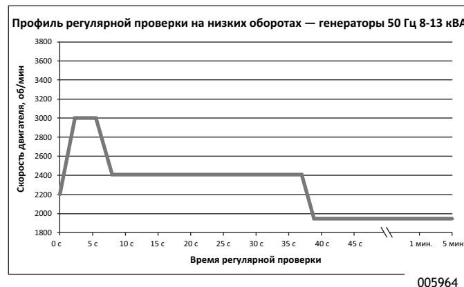
Рисунок 3-9. Профиль тренировки на малой скорости
