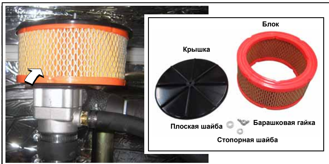
Рис. 5-13. Крышка воздухоочистителя и блок фильтра
