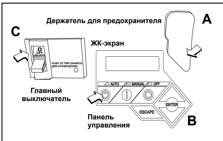
Рис. 5-16. Панель управления генератора
